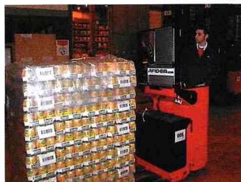
Chaque étiquette RFID contient le code SSCC (Serial Shipping Container Code), permettant d'identifier de façon unique une entité logistique: palette, colis, etc.
